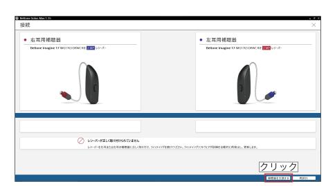
誤装着防止確認と安全確認のため、再度 エラーメッセージが表示されます。 「補聴器を交換する」をクリックして、左右 を変更します。
