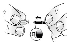
新しいセルストップがついている側をレーザー孔にあわせます。
