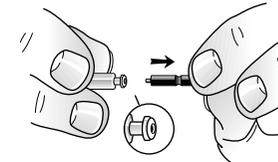
治具をひっぱりレーザー孔にセルストップが残れば完了です。
