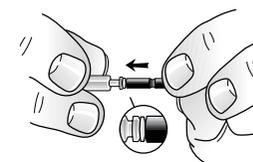
そのままレーザー孔にセルストップをさし込みます。
